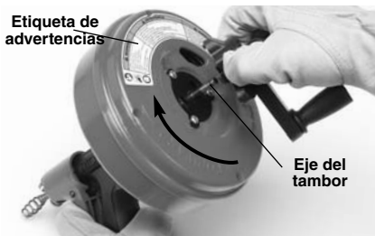
Figura 2 – Extracción de la manivela fuera del Power-Spin
