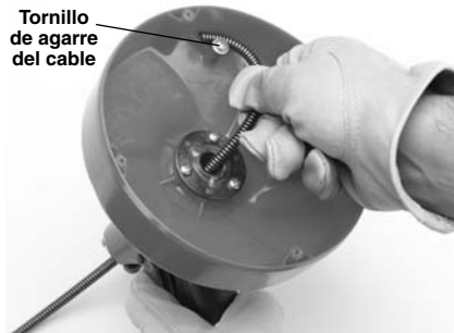
Figura 9 – Sujeción de la cola del cable
