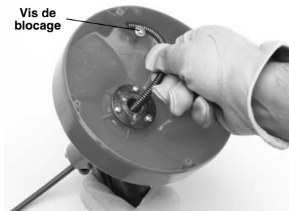
Figure 9 – Engagemment du câble dans la bride
